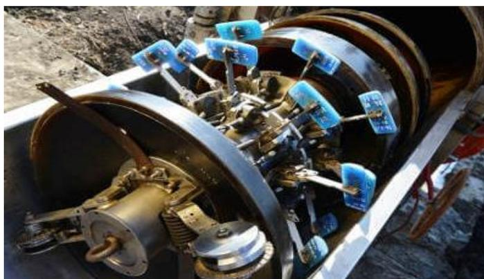
Рисунок 3. Неразрушающий контроль трубопровода электромагнитным методом
