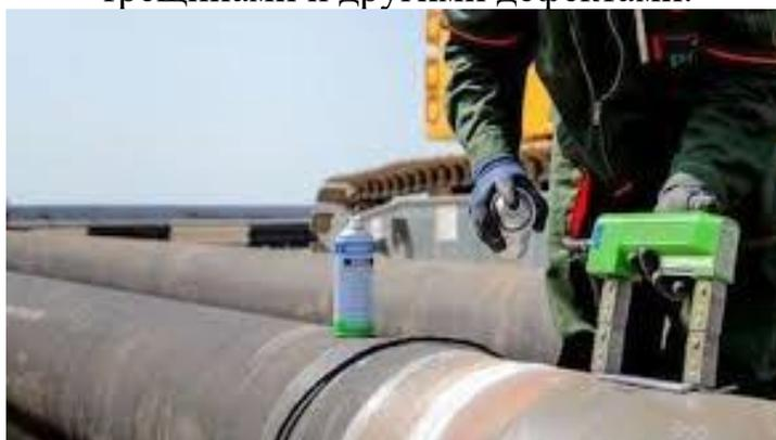
Рисунок 2. Неразрушающий контроль трубопровода магнитопорошкового метода
